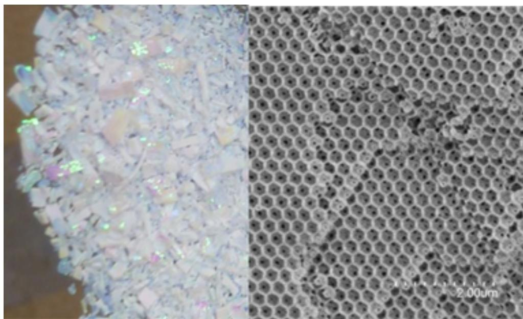
Combiner différentes compétences pour réaliser un projet : exemple d'opales inverses synthétisées par combinaison de chimie macromoléculaire et douce par voie sol-gel (gauche) et observée au microscope électronique à balayage (droite).
